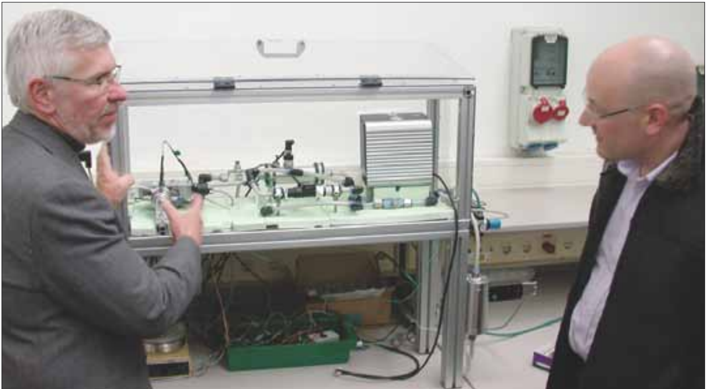
Äußerlich wenig spektakulär, von der Konstruktion her aber aufwändig durchdacht und mit feinmechanischer Präzision gefertigt: Prof. Stefan Rösler (links) und Dr. Peter Kress vor dem Versuchsstand für die Ermittlung von Strömungs-, Widerstands- und anderen Werten der vielen verschiedenen Stimmprothesen-Modelle in der Esslinger Hochschule.
